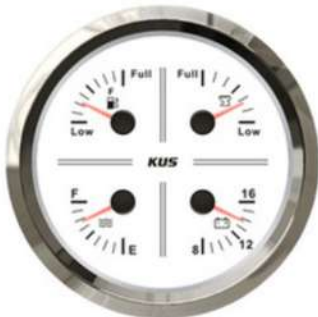
ED0553 Kus 4'lü Temiz Su + Pis Su + Yakıt + 12V Voltmetre Göstergesi Beyaz 110mm Benzin: 0-190 Ohm Temiz Su: 0-190 Ohm Pis Su: 240-33 Ohm
