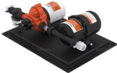
ED09680 Seaflo Tanklı Hidrofor 12 V - 11.3 lt. / dk Tank: 0,75 lt , 45 Psi, 26x37 cm, Çıkış: 13 mm
