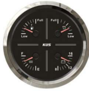
ED0554 Kus 4'lü Temiz Su + Pis Su + Yakıt + 12V Voltmetre Göstergesi Siyah 110mm Benzin: 0-190 Ohm Temiz Su: 0-190 Ohm Pis Su: 240-33 Ohm
