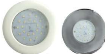
Sıva Üstü Led Spot 75 mm çap Mavi - Beyaz -Gün Işığı (Montaj için sadece kablo deliği yeterlidir) 12-24 Volt
